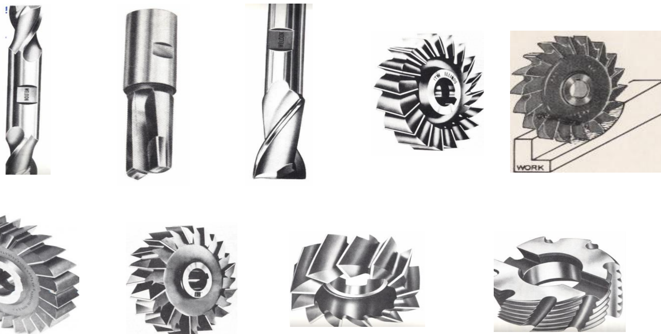
Hình 7.1. Các loại dao thường dùng để phay bậc vuông góc.
