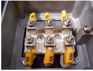
Hình 3.21 Động cơ được nối theo hình sao
