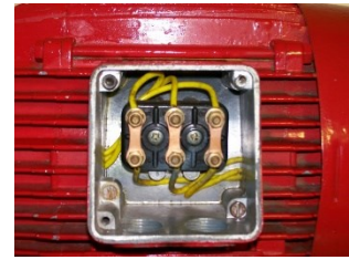
Hình 3.22 Động cơ được nối theo hình tam giác
