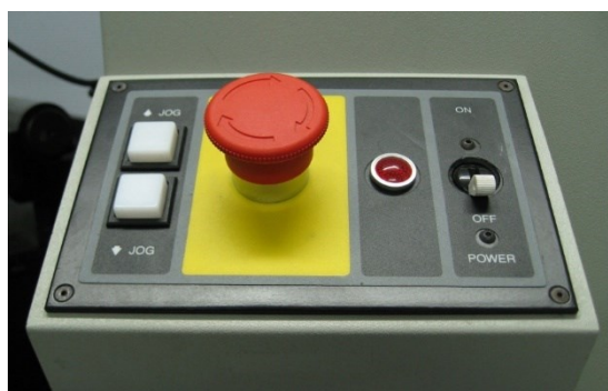
Hình 1.42 Nút nhấn dừng trong mạch bảo vệ (Emergency stop).
