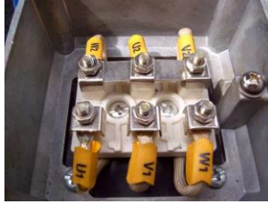
Hình 13.3 Động cơ được nối theo hình sao
