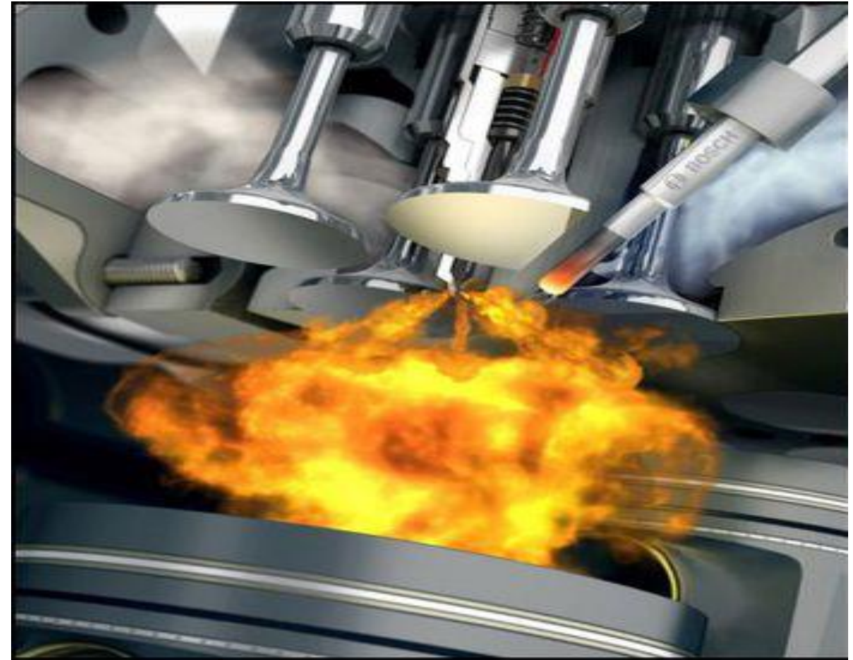
Tự bắt cháy do áp suất cao trong động cơ diesel
