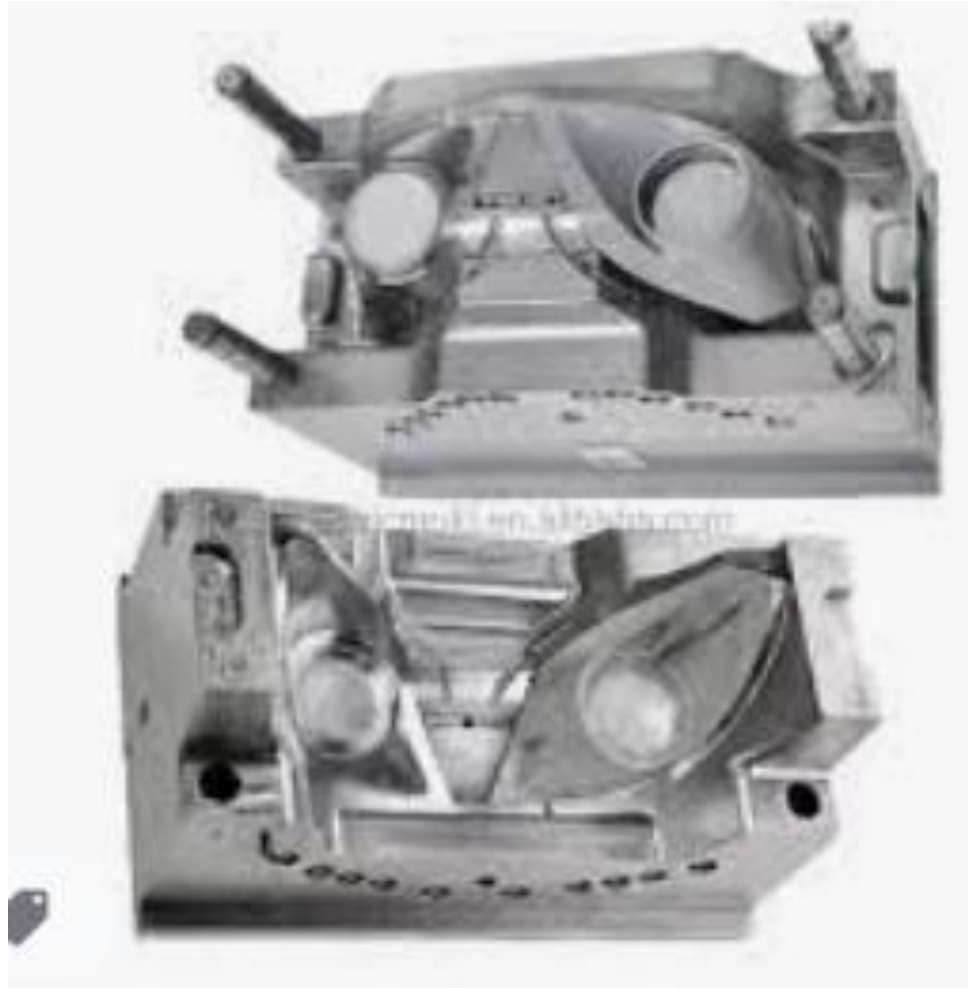
Hình 31- 8: Thép NAK80- khuôn đèn xe
