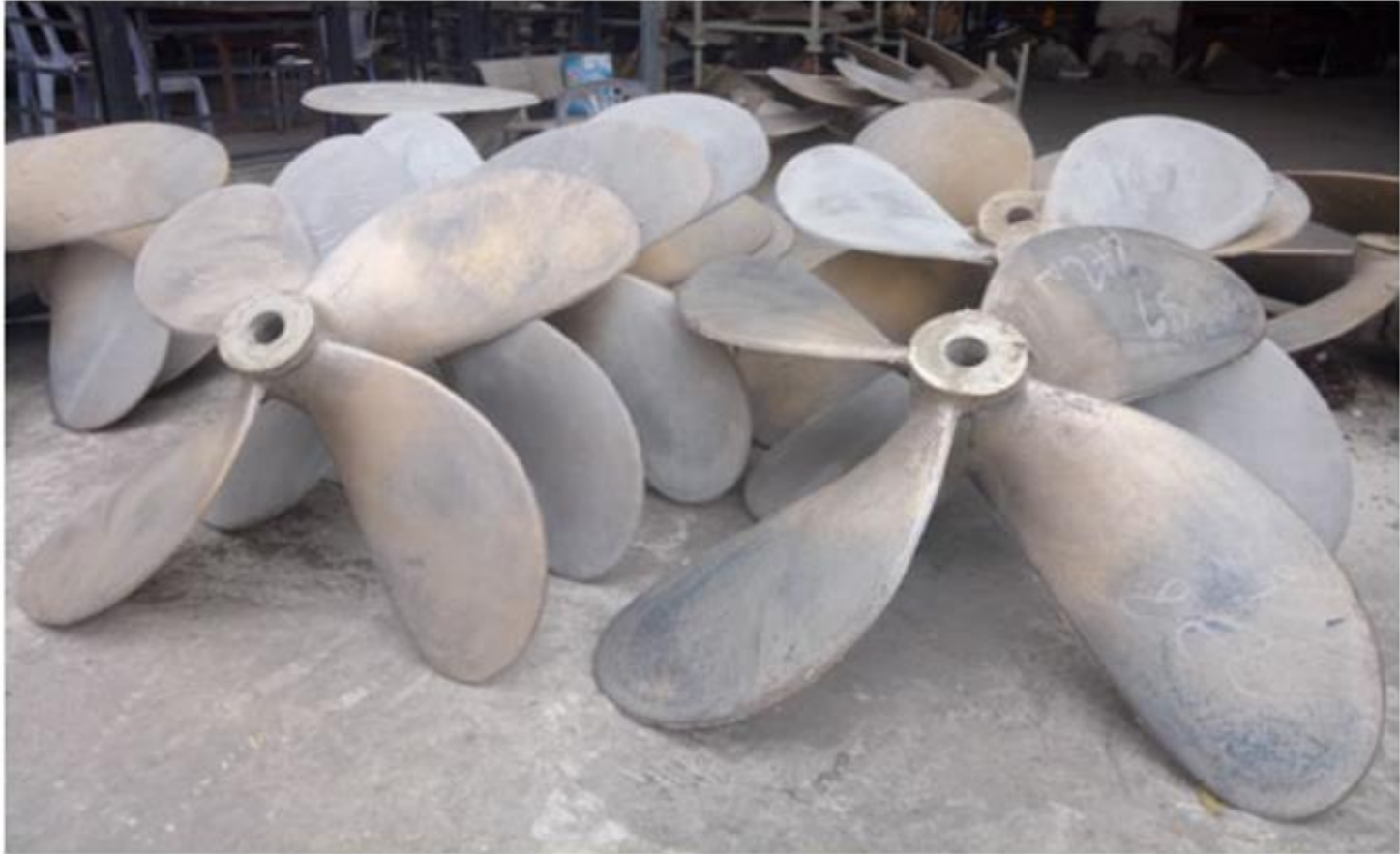
Hình 32- 11: Cánh quạt đúc bằng khuôn cát
