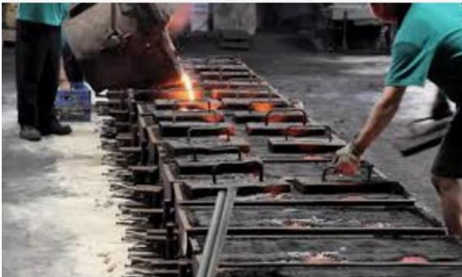
Hình 32- 9: Đúc sản phẩm bằng khuôn cát
