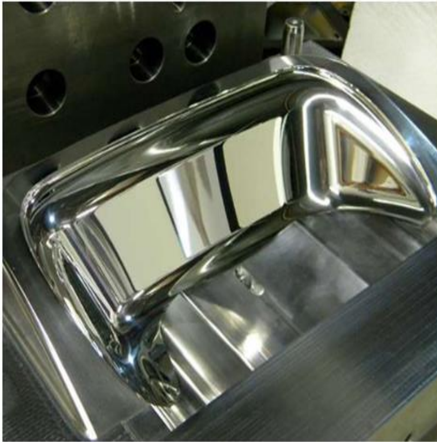
Hình 33 - 12: Đánh bóng khuôn đèn xe – phôi PET
