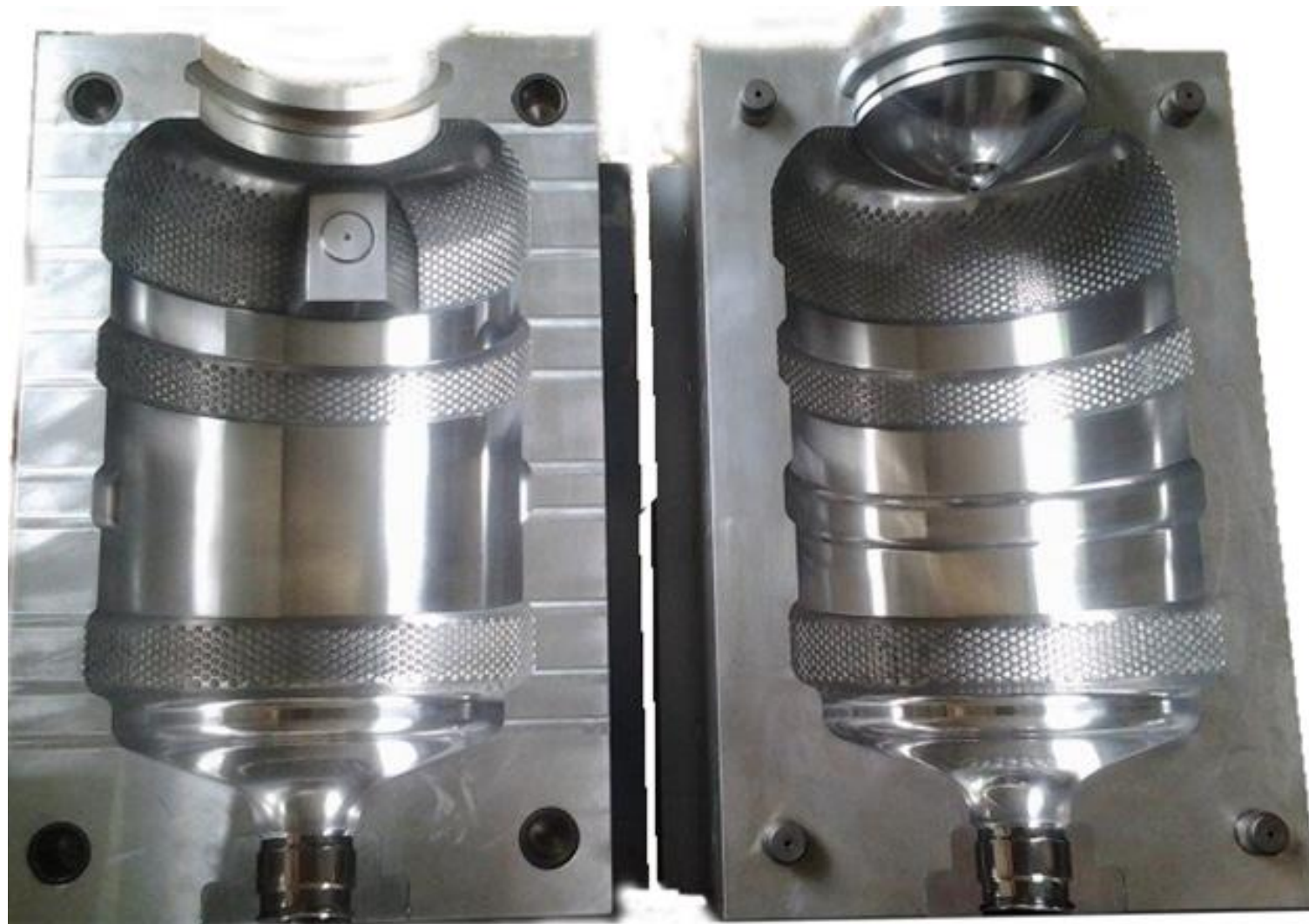
Hình 33 - 18: Xi mạ Crom khuôn bình nước 20L
