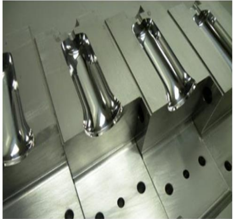
Hình 33 - 12: Đánh bóng khuôn đèn xe – phôi PET
