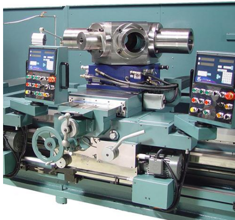
Hình 11.4 Một máy công cụ với nhiều vị trí Nút nhấn điều khiển
