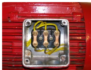
Hình 13.4 Động cơ được nối theo hình tam giác
