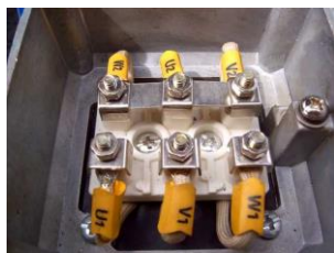
Hình 13.3 Động cơ được nối theo hình sao
