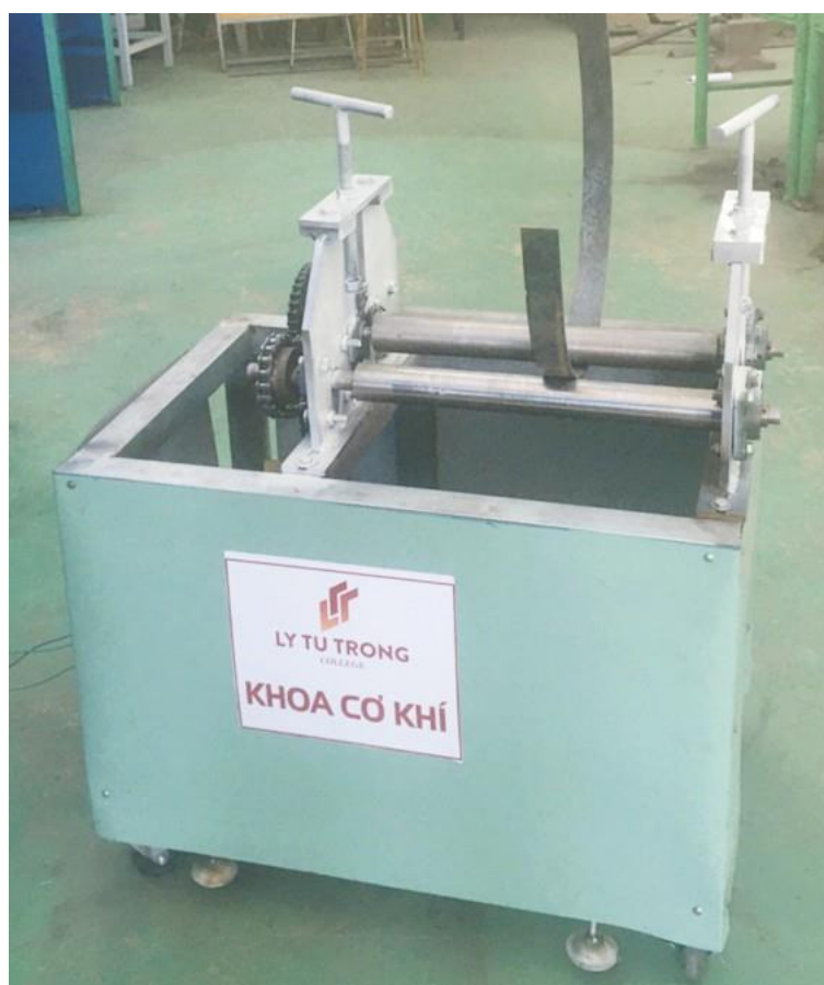
Hình 6: Sản phẩm máy uốn thép đa năng đang trong giai đoạn hoàn thiện
