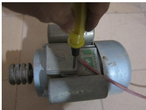
Hình 1.4.3b Dùng tuốc-nơ-vít siết các vít bắt nắp hộp đấu dây
