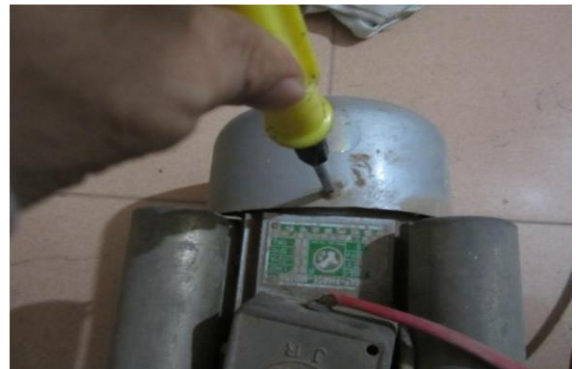
Hình 1.3.2a Dùng tuốcnovít tháo các vít bắt nắp sau với stator
