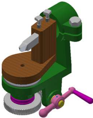
Hình 45. Mô hình lắp ráp bàn dao gia công mặt cầu
