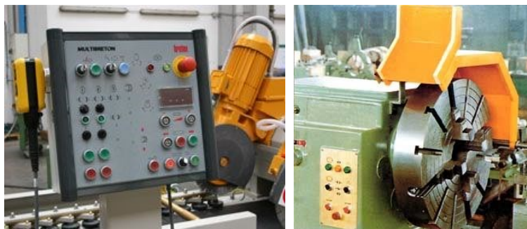
Hình 1.44 Bảng điều khiển sử dụng Nút nhấn trên các máy công cụ
