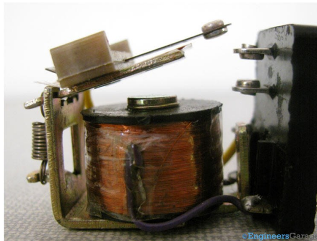
Hình 1.54 Bên trong một Rơ le điện từ kiểu bản lề
