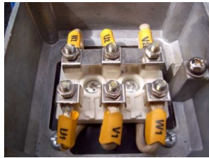
Hình 3.21 Động cơ được nối theo hình sao
