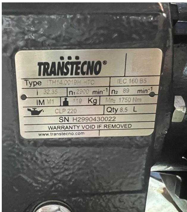
Hình 10: Hộp giảm tốc hãng TRANSTECNO
