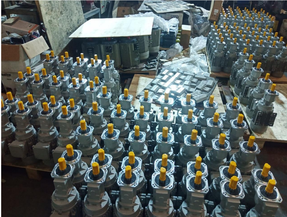
Hình 12: Động cơ không đồng bộ có hộp giảm tốc để điều khiển băng tải ngành chăn nuôi
