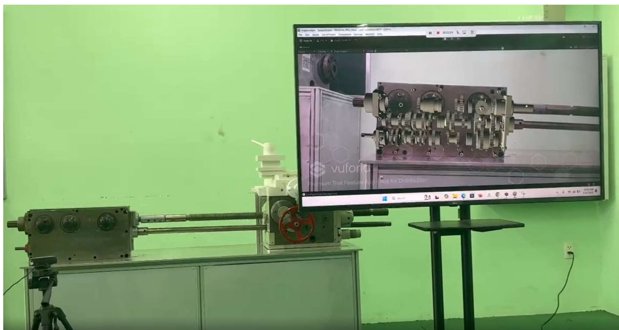
Hình 4.1: Hình ảnh thực tế ảo các chi tiết bên trong của hộp bước tiến
