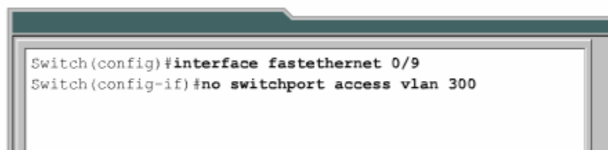
Hình 8.2.6. Xoá port 0/9 khỏi VLAN 300.
