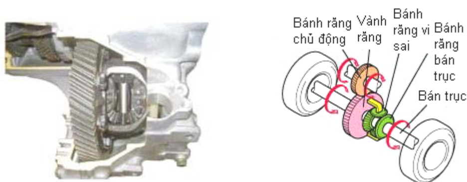
Hình 3.27: Cấu tạo bộ vi sai động cơ đặt trước cầu trước chủ
