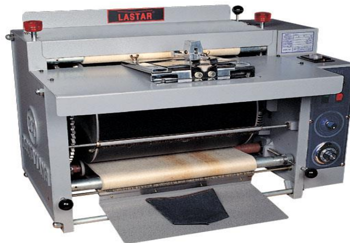
Hình 4.14: Máy ủi định hình túi quần jean chuyên bó
