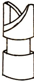
Hình 10-16. Piston bơm cao áp có cạnh xiên vát trên, tự động phun dầu sớm
